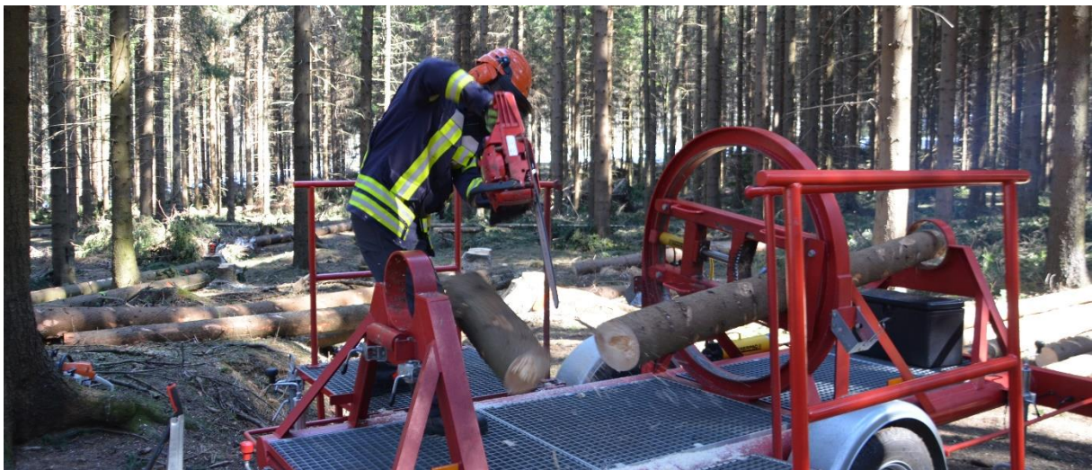
Am Baumbiegesimulator können gefährliche Situationen gefahrlos simuliert werden.
