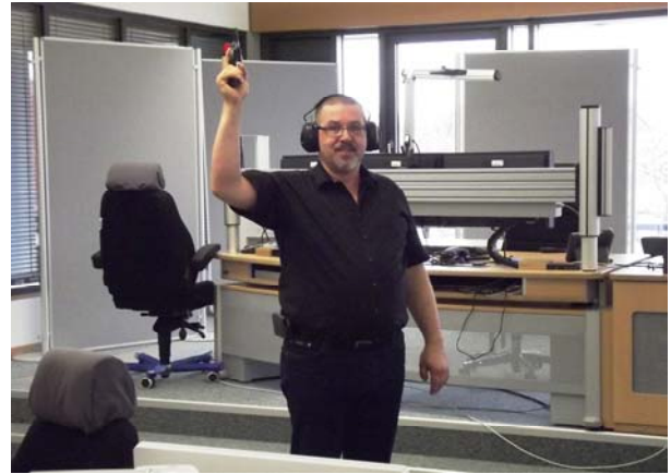
PHK Zimmermann beim Erzeugen des Schallimpulses mit der Schreckschusspistole
